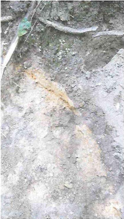
Unidad de piroclásticos en contacto con la unidad de andesitas alteradas, dicho contacto es discordante por lo que se encuentra una línea estructural N 10 W que es el lineamiento principal de toda la zona estudiada de acuerdo con los estéreo diagramas de abajo
